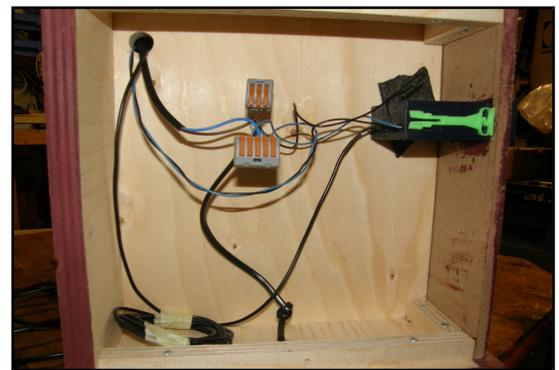
Le câble de la sonde de température doit pouvoir être tiré et déplacé dans la couveuse. Il ne doit pas être raccourci.
