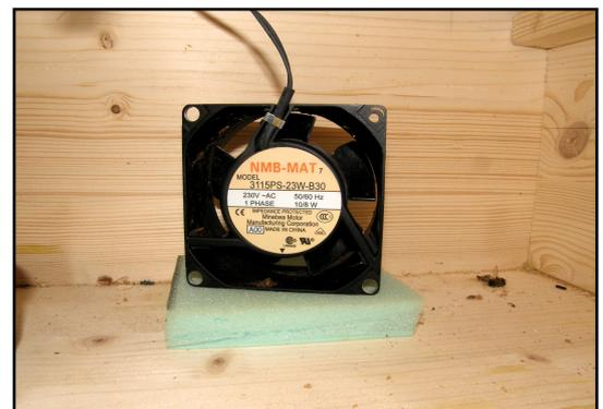
Le ventilateur peut être suspendu ou posé sur de la mousse. Il ne doit pas transmettre de vibrations.
