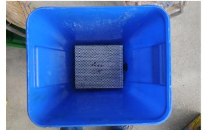
Le fond de la chaudière est garni d'une grille en aluminium qui permet de maintenir les cadres et les débris en dessus du niveau de la sortie de l'écoulement.
