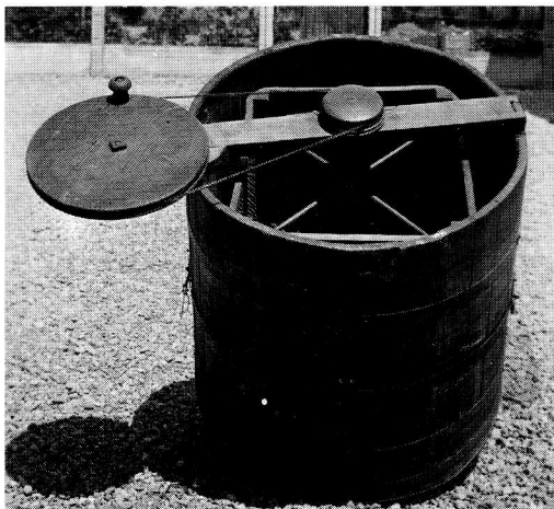
Extracteur avec cuve de bois, poulie à 3 vitesses et traction à corde, en service dans la famille Roussy, à Aigle, de 1883 à 1928.
